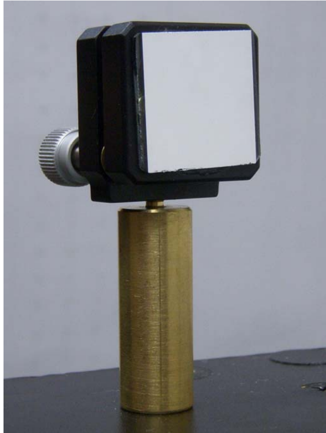
Огледало на подесивом држачу са два завртња за подешавање и стубићу (ОЗНАКА В)
