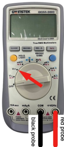
Слика P-3. приказује мултиметар коришћен у овом примеру заједно са положајем сонди и избором врсте мерења.
