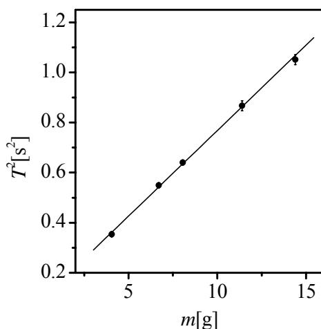
Са графика  $T^2 = f(m)$ , одређује се коефицијент правца праве избором две неексперименталне тачке, нпр. А (5.3g; 0.45s<sup>2</sup>) између прве и друге и В (12.6g; 0.95s<sup>2</sup>) између последње и претпоследње експерименталне тачке.
